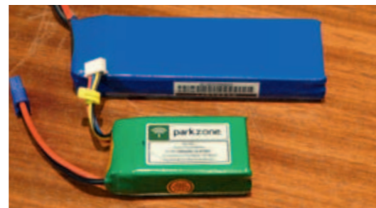
Der neue Akku ist wesentlich größer: 3.000 statt 1.350 Milliamperestunden Kapazität. Gewichtszunahme rund 120 Gramm
