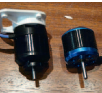
Größenvergleich. Der Austauschmotor rechts hat die gleichen Maße und das gleiche Gewicht, aber mehr Leistung. Man beachte die unterschiedliche Ausrichtung der Motorwelle
