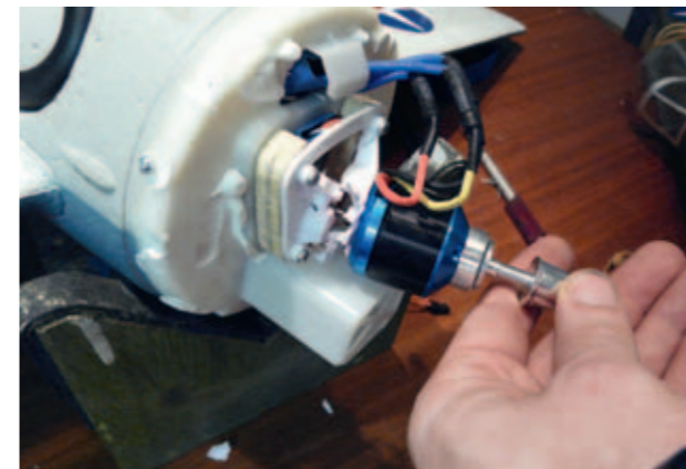
Der neue Motor war definitiv zu drehmomentfreudig für den Kunststoff-Motorspant, der dann vollständig ersetzt werden musste
