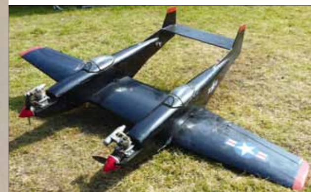
Die kastigen Rümpfe, keine Motorgondeln und eine schlichte Flächenkonstruktion erleichtern den Bau der P-82
