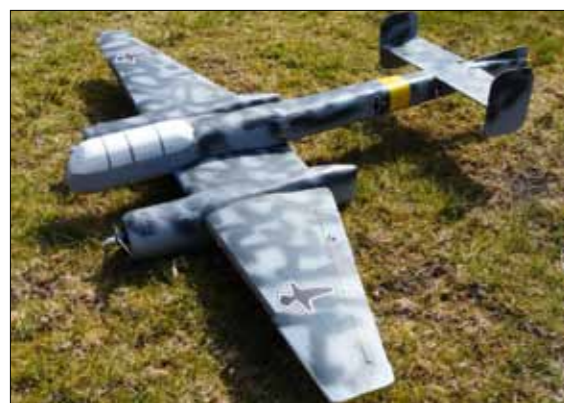
Aus nur neun Styro-Elementen ist die Arado 240 zusammgebaut, was den Bauaufwand stark reduziert
