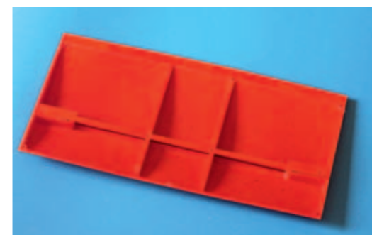
Innerer Teil der Tragflächen mit eingelassenem Holm
