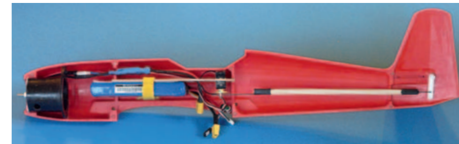
Der Akku hängt kopfüber am Akkubrett im Rumpf und wird von Klettband gehalten
